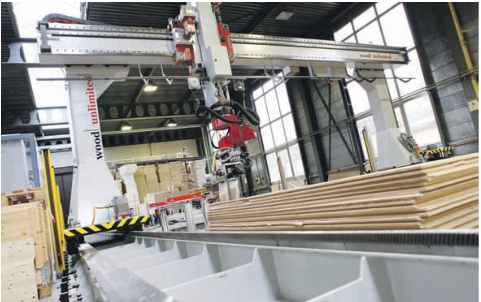
Die 32 Meter lange robotergesteuerte Holzbearbeitungsanlage kann ganze Wände für Holzhäuser komplett fertigen.
