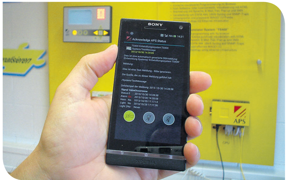
Der visuelle oder akustische Alarm lässt sich quittieren, der Status der Anlage, die den Alarm ausgelöst hat, überprüfen.
